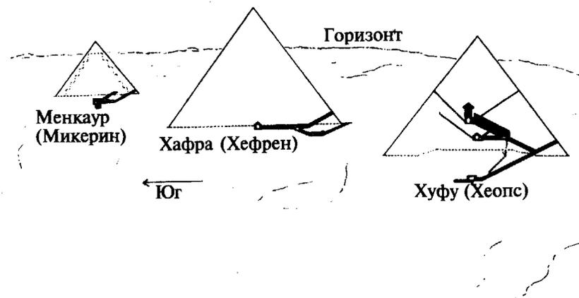
**Рис. 7. Внутренние коридоры и проходы трех пирамид в Гизе**
