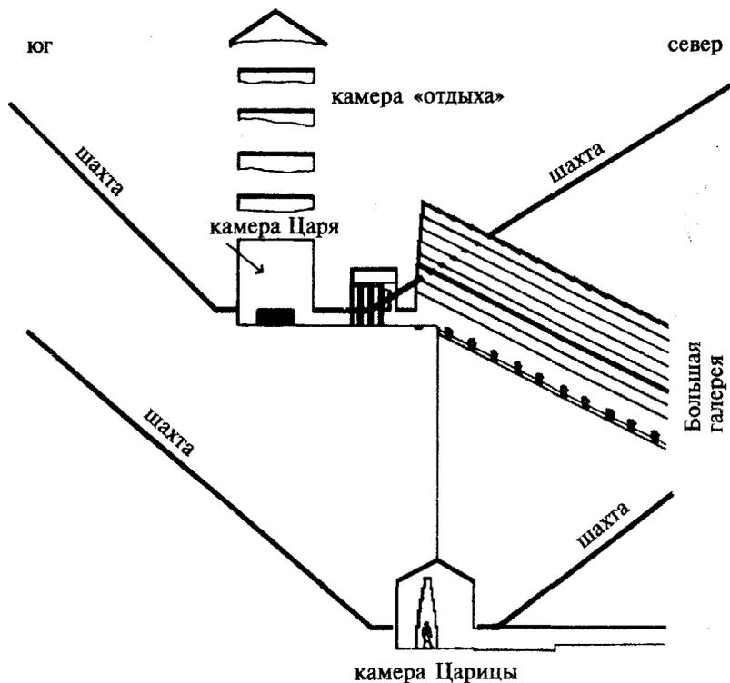
**Рис. 11.** Камеры Царя и Царицы и их четыре шахты. Обратите внимание, что шахты камеры Царицы первоначально не соединялись с камерой, а заканчивались тупиком в нескольких дюймах за стенкой. Доступ в шахты был вскрыт в 1872 году английским инженером Уэйнменом Диксоном
