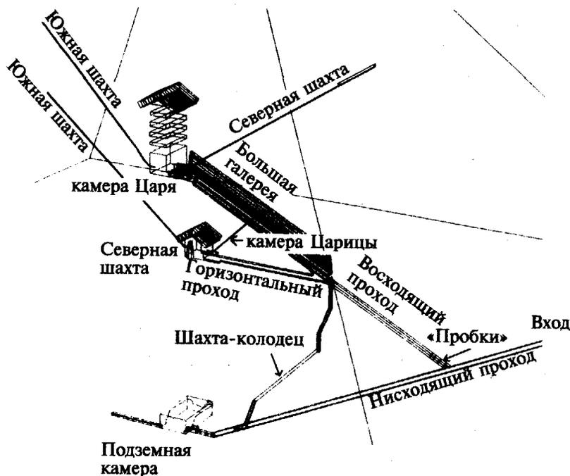
**Рис. 10. Схема внутреннего устройства Великой пирамиды. Возможно, что внутри этого гигантского монумента будет найдено еще много новых проходов и камер**
