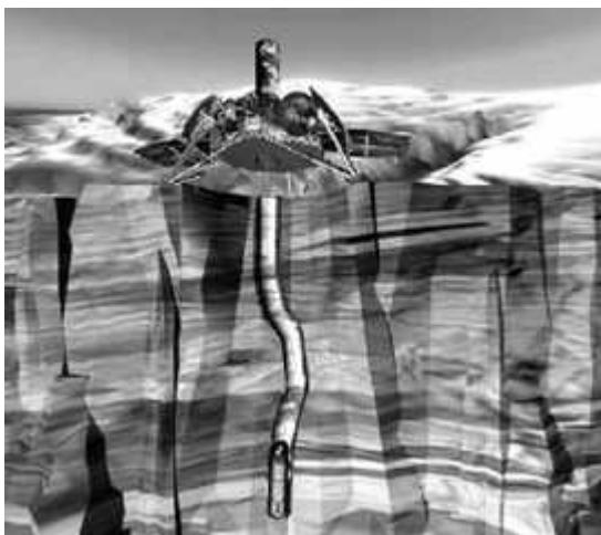
**Благодаря гравитации зонд начинает погружаться в тоннель, который сам же расплавляет в толще льда.**
