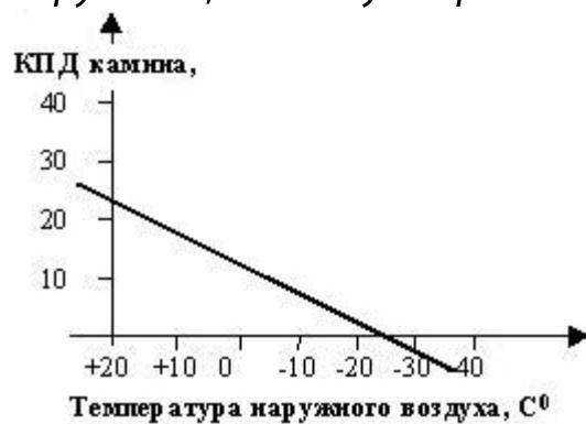
**КОЭФФИЦИЕНТ ПОЛЕЗНОГО ДЕЙСТВИЯ (КПД) ПЕЧИ -1)**
