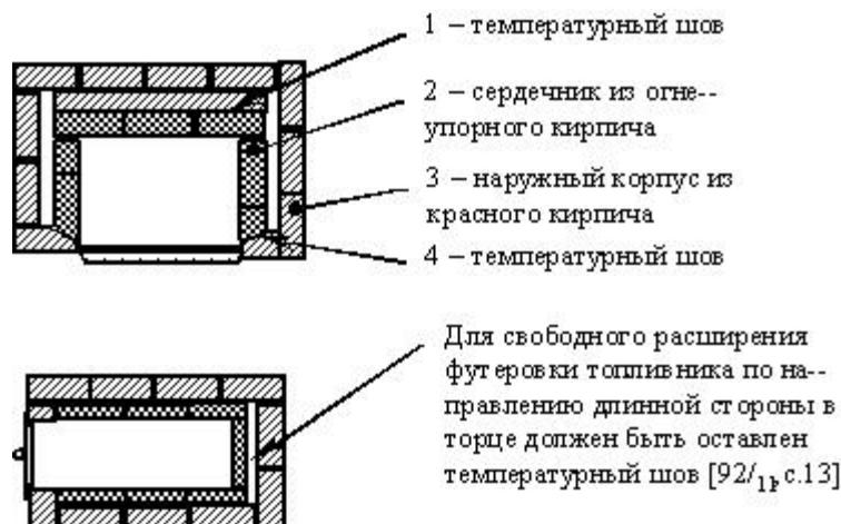
**ТЕПЛОВАЯ КАССЕТА (ВСТАВКА)** состоит из двух отделений: тепловой вставки и конвекционной камеры. Кассета вставляется в конвекционную камеру. Отдача тепла кассетой происходит благодаря циркуляции воздуха в конвекционной камере, нагревшего тепловой вставкой. Тепловая вставка снабжена колосниками, зольниковым
