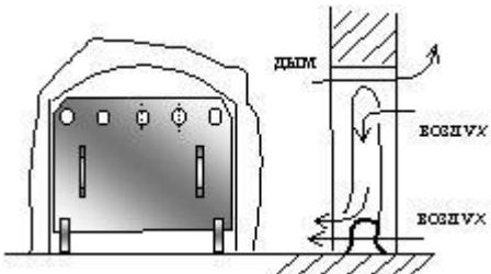
условий сжигания дров в существующих традиционных русских печах. Заслонки ставятся в устье печи и служат для пропускания в нижнюю щель воздуха, а в верхнюю — продуктов горения, направляющихся в трубу [190, с.94].
