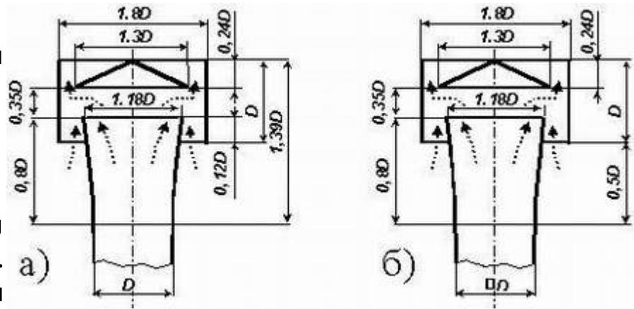
выбирают в соответствии с диаметром вытяжной трубы  $D$  (см. рис.а). Примерно таковы же пропорции и для дефлектора на трубу квадратного сечения со стороной  $D$  (см. рис.б). Заметим одновременно, что дефлектор не разрешается ставить на печную трубу в связи с тем, что при сильном ветре тяга возрастает настолько, что из трубы начинают вылетать искры, что грозит пожаром [765,с.27]
