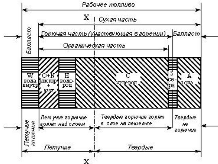
Схема элементарного состава топлива
