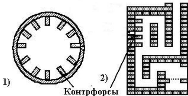
**КОНВЕКТИВНАЯ СИСТЕМА (СИСТЕМА ДЫМООБРОТОВ)** — служит для наиболее полного использования теплоты образовавшихся в топливнике продуктов сгорания [257, с.7].
