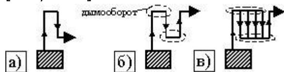
**ДЫМООБОРЫ** — это каналы, которые устраивают в корпусе печи для пропуска дымовых газов с таким расчетом.
