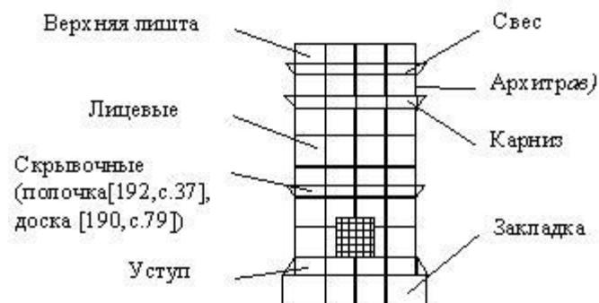
**ИЗРАЗЦЫ (КАФЛИ** [163, с.26]) — глиняные плитки для облицовки наружных по-верхностей нагревательных приборов.
