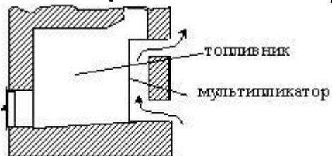
**МУЛЬТИПЛИКАТОРЫ** — 1) В начале 20 века для повышения КПД печей сильно рекламировались чугунные ребристые ящики, вставляемые в топливник в качестве ребристых внутренних стенок топливника — мультиплекаторы инженера Клобуковского.
