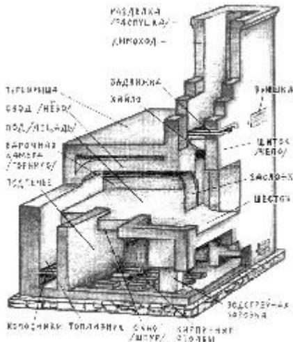
Устройство усовершенствованной русской печи с нижним прогревом [588/1, с.97].
