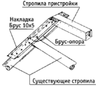
Рис. 2 Узел А. Стыковка стропил
