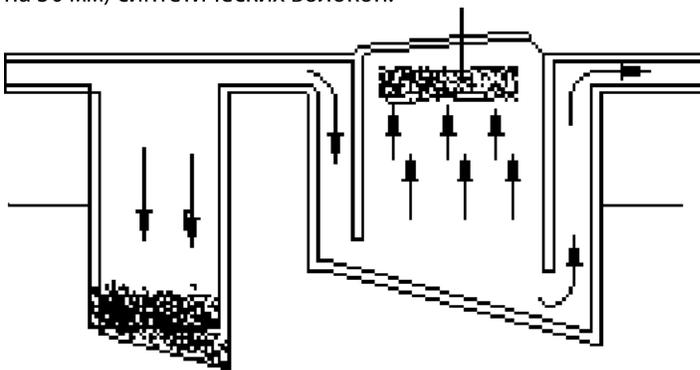
Рис. 2.6. Жироловушка с грязевиком [18]
