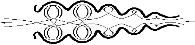
Рис. 2.5. Схема тока воды в водной лесенке [31]
