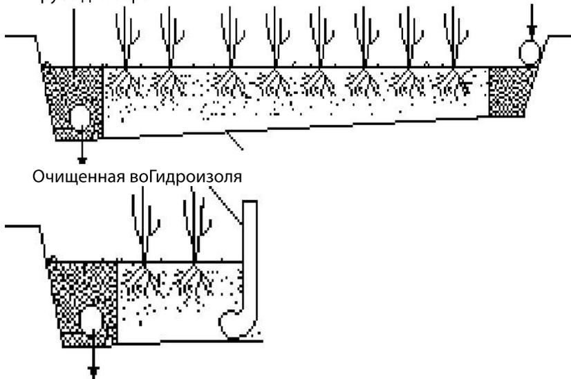
Рис. 2.18. Камышево-гравийная площадка [39]: а - система Кикуса; б - система Сейдаль. См. также [1,2, 25, 38].
