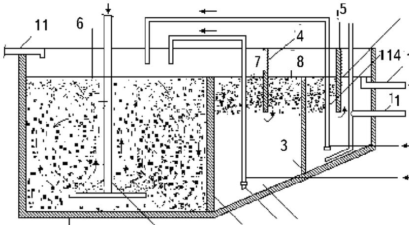
Рис. 2.22. Биофильтр с плавающей загрузкой [72]:
