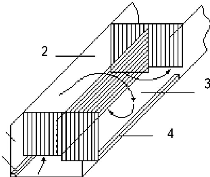
Рис. 2.23. Аэротенк - вытеснитель [80]:
