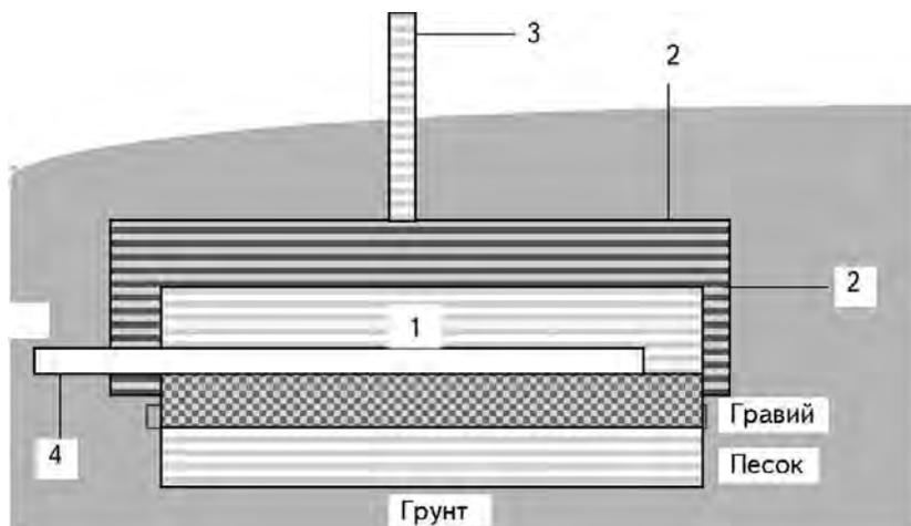
Рис. 2.13. Фильтрующая кассета [4]
