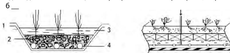
Рис. 2.20. Канал биологической очистки с твердой фильтрующей загрузкой (а) [56] и аэратором (б) [57]: 1- гидроизоляция; 2 - фильтрующий материал; 3 - вода; 4 - водопримные дрены отвода профильтрованной воды; 5 - аэратор.
