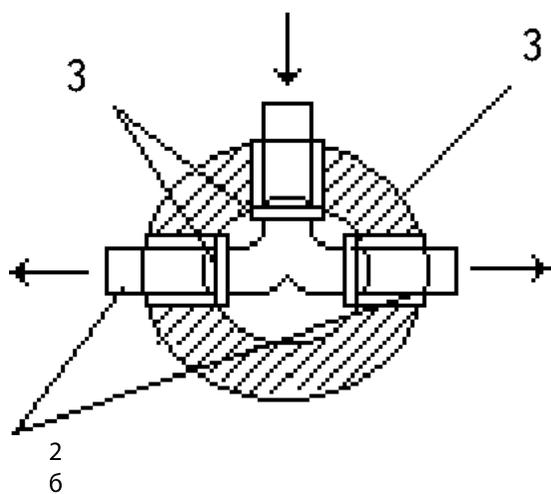
Рис. 2.7. Распределительный колодец (а - вид сбоку; б - вид сверху) [17]:
