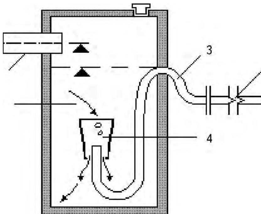
Рис. 2.3. Септик с камерой разделения, помещенной в камеру брожения [22]:
