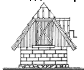
Рис. 3. Крыша колодца из черепицы
